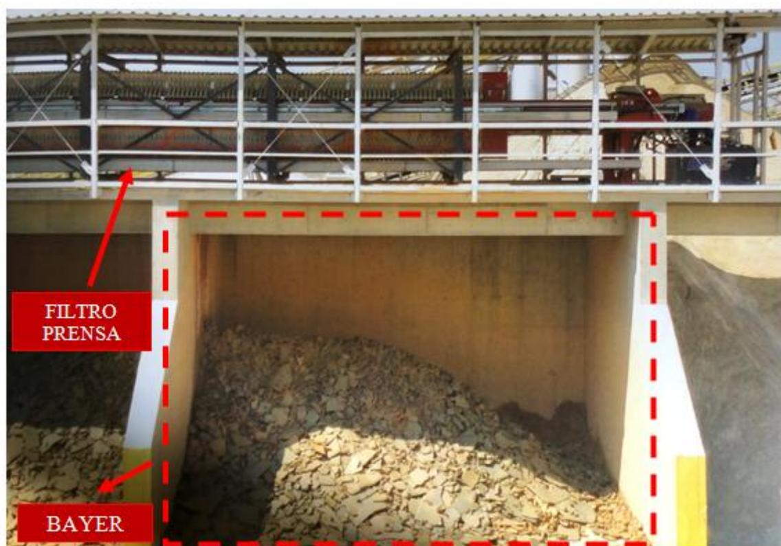
Cada filtro operacional conta com 1 (uma) pá-carregadeira e 3 (três) ou 4 (quatro) caminhões para realizarem o carregamento e o transporte do material. Na pilha de disposição compartilhada de estéril/rejeito, denominada Cachoeirinha, ficam 3 (três) tratores que realizam a distribuição e compactação do material.
