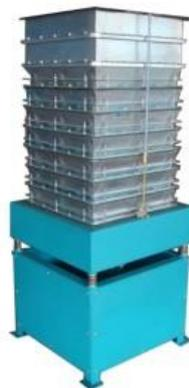
Figure 12 - Peneirador Vibratório
