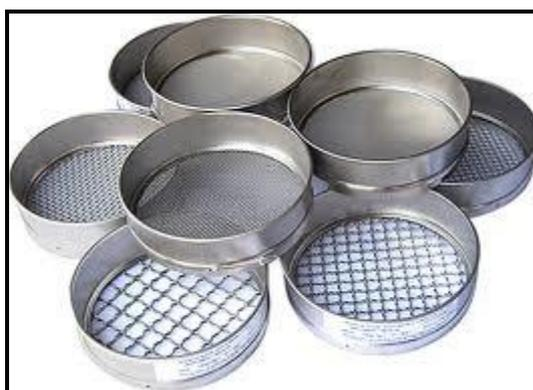
Figure 15 - Peneiras Utilizadas na Análise Granulométrica.
