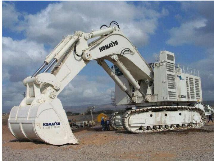
Figura 17: Escavadeira Hidráulica Komatsu PC8000
