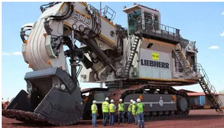
*Figura 34: Escavadeira hidráulica Liebherr R9800.*
