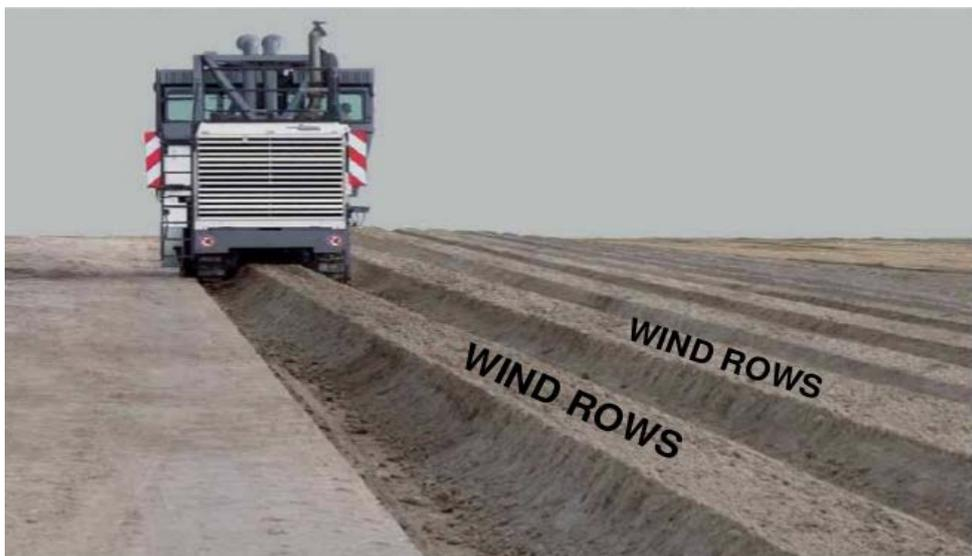
FIGURA 24: Esquematização windrowing
