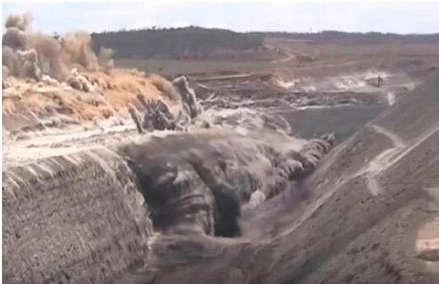
FIGURA 3: Exemplo de cast blasting
