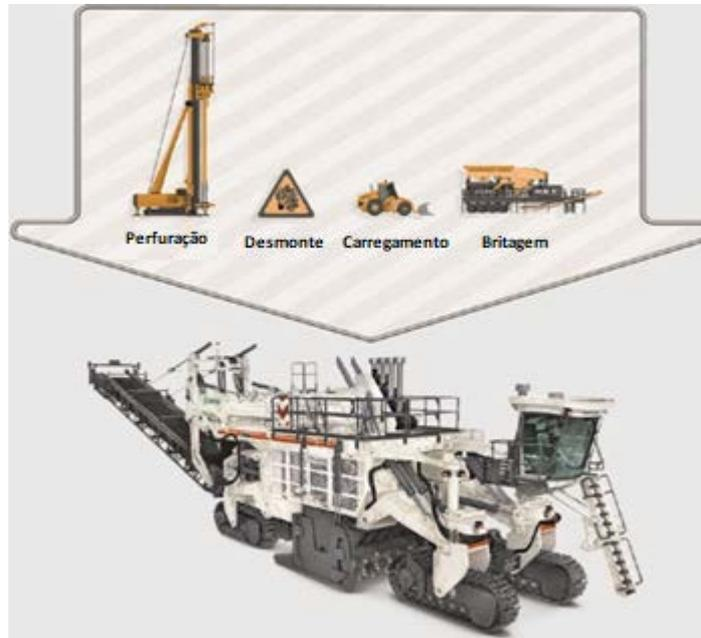
FIGURA 25: Etapas substituíveis pelo minerador de superfície
