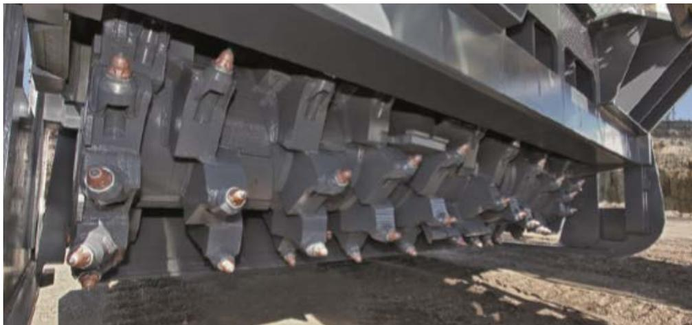
FIGURA 17: Disco de corte de um minerador de superfície (WIRTGEN)
