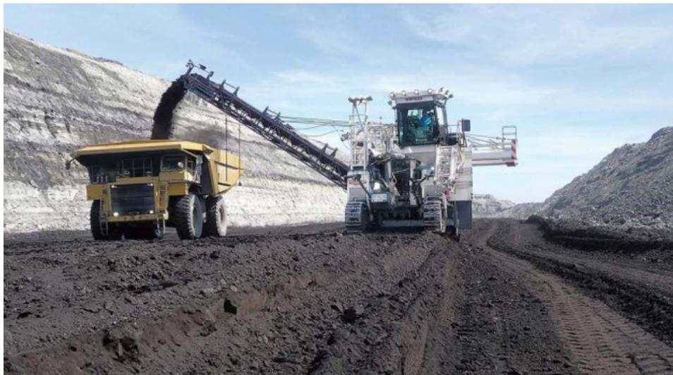
FIGURA 8: Minerador de superfície – direct loading
